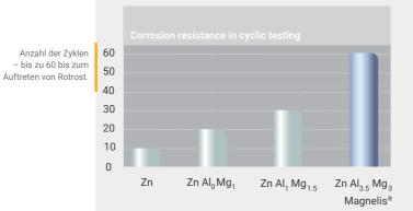
Die 10-µm-Beschichtung wurde abwechselnd einem 8-stündigen Nebelzyklus (5% NaCl) / Trockenzyklus / Feuchtigkeitszyklus unterzogen. Quelle: Das globale Forschungs- und Entwicklungszentrum von ArcelorMittal.
